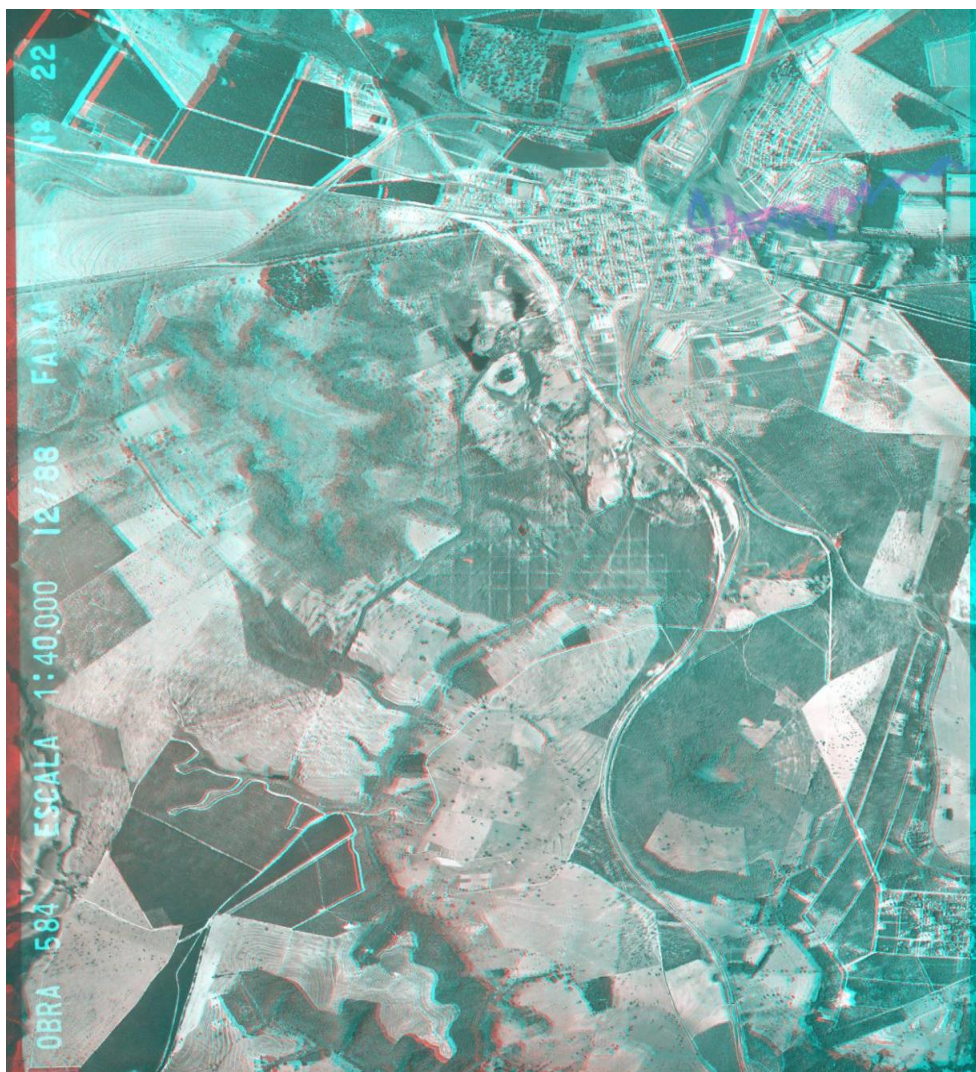
Figura 6- Imagem anáglifo gerada a partir da utilização do software StereoPhoto Marker 5.20 .
