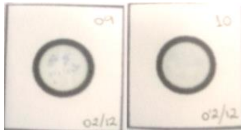
Figura 10 – Spot-tests da reação entre a solução de ditionito de sódio + ácido ascórbico em meio alcalino e a solução de paraquat , cerca de 3 minutos após o surgimento da coloração. À esquerda solução de dicloreto de paraquat 200 mg L -1 e à direita solução de dicloreto de paraquat 20 mg L -1 .
