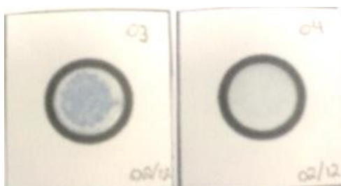
Figura 6 – Spot-tests do produto da reação entre a solução de ditonito de sódio em meio alcalino e a solução de paraquat . À esquerda solução de dicloreto de paraquat 200 mg L -1 e à direita solução de dicloreto de paraquat 20 mg L -1 .
