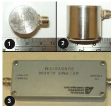
Figura 25 – Módulo de emissão acústica utilizado. 1) e 2) sensor piezoelétrico, e 3) amplificador de sinal
