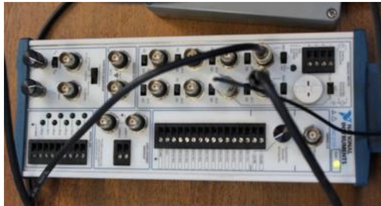
Figura 21 – Sistema de aquisição de dados em que estavam conectados os sensores e a placa de aquisição de dados
