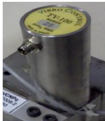
Figura 24 - Módulo de vibração modelo TV100
