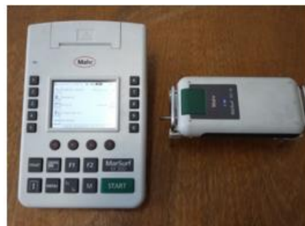
Figura 26 - Rugosímetro da marca Mahr, modelo Marsurf M300
