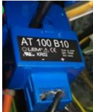
Figura 23 - Sensor de Efeito Hall, marca LEM, modelo AT100 B10
