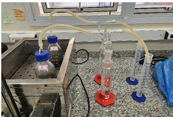
Figura 10 - Configuração da montagem do ensaio de AME
