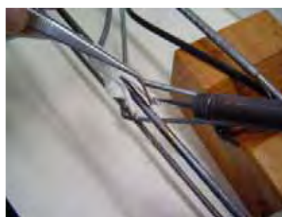
Solda dos terminais
