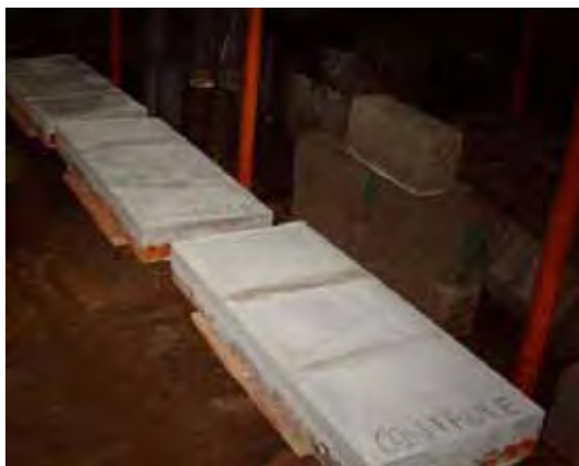
Figura 25: Desmoldagem e cura dos modelos M-100
