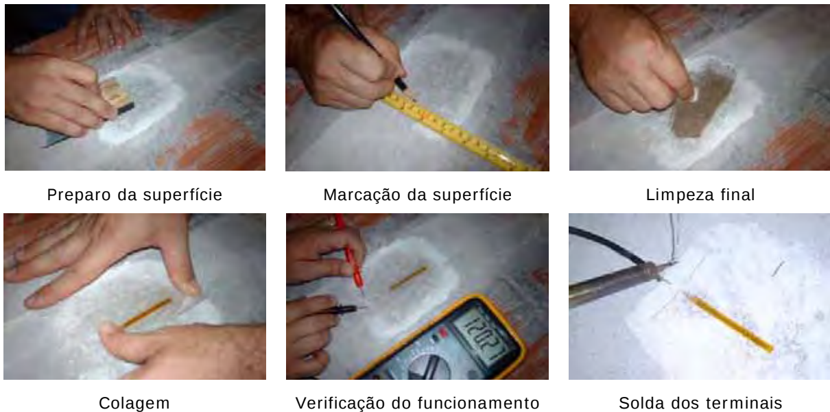
Figura 31: Aplicação do extensômetro elétrico na superfície inferior dos modelos M-100
