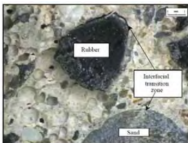
Figura 14: Zonas de transição “pasta de cimento-borracha” e “pasta de cimento-areia”
