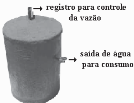
Figura 9: Armazenador térmico alternativo construído em fibra de vidro. (SOUZA, 2006)
