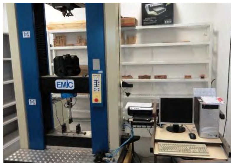
FIGURA 28 – Máquina universal de ensaios utilizada para realização dos testes mecânicos.
