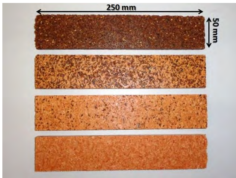
FIGURA 29 – Corpos de prova de flexão estática, provenientes do tratamento 1, 2, 3 e 4, de baixo para cima, respectivamente.
