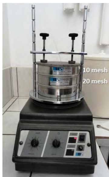
FIGURA 14 – Agitador de peneiras utilizado para a classificação das partículas.
