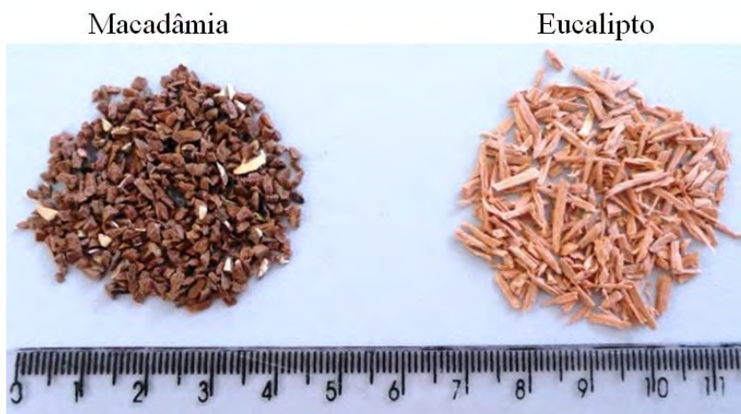
FIGURA 15 – Partículas de eucalipto e de casca de macadâmia da peneira de 20 mesh.
