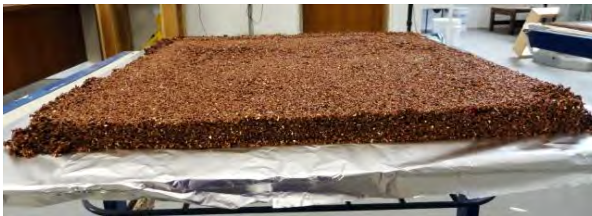
FIGURA 19 – Colchão de partículas do painel de 100% de macadâmia após a pré-prensagem.
