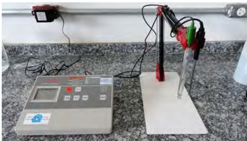
FIGURA 24 – pHmetro utilizado na determinação do pH
