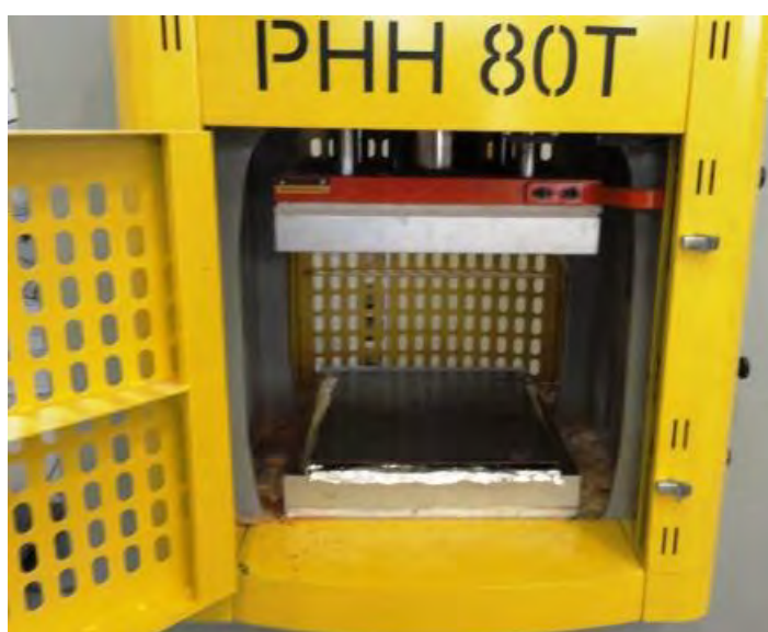
FIGURA 20 – Prensa utilizada na prensagem dos painéis.
