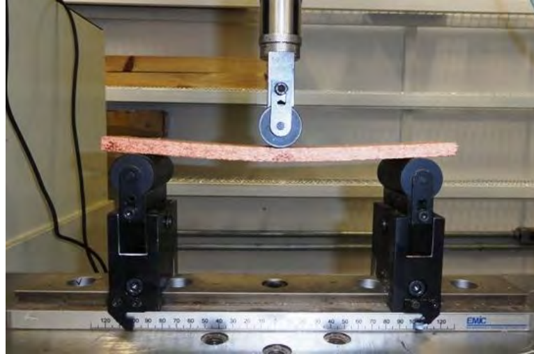
FIGURA 30 – Ensaio de flexão sendo realizado na máquina universal de ensaios.
