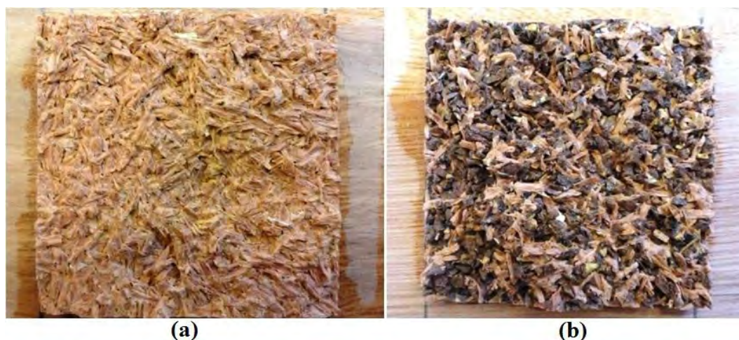
FIGURA 44 – Corpos de prova de adesão interna rompidos; (a) 0% macadâmia; (b) 70% macadâmia.
