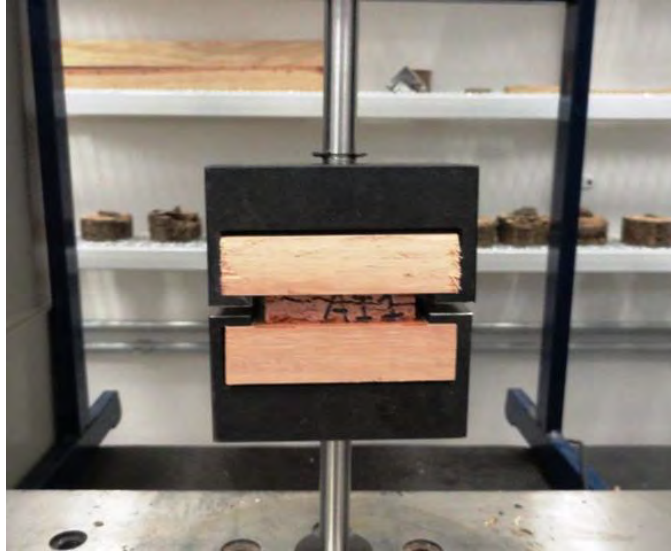
FIGURA 32 – Ensaio de tração perpendicular na máquina universal de ensaios.
