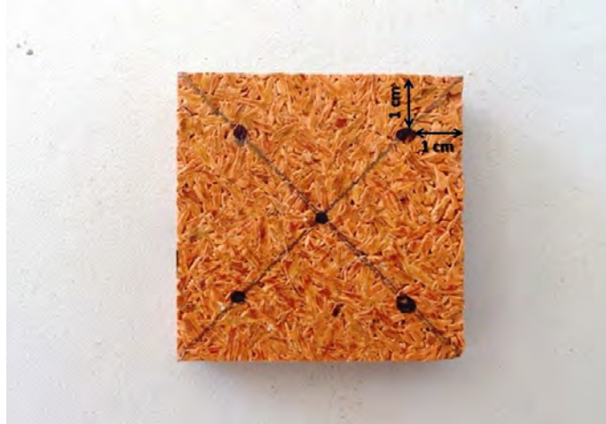
FIGURA 26 – Medição da espessura do corpo de prova em cinco pontos.
