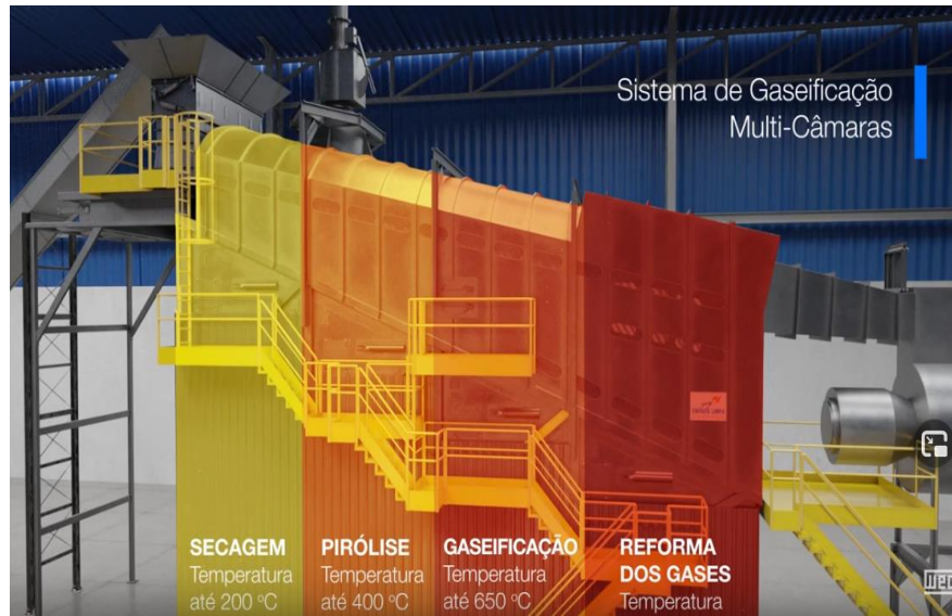
Figura 5.3 – Sistema de câmaras da planta de gaseificação da WEG.
