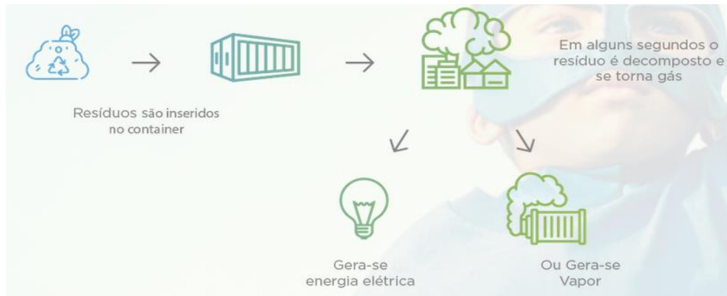
Figura 5.2 – Imagem ilustrativa de como funciona a FDS da ZEG.
