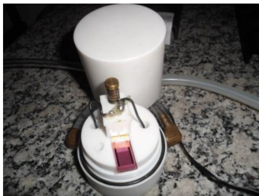
Figura 12 - Sistema para submeter o sensor ao fluxo de vapores.
