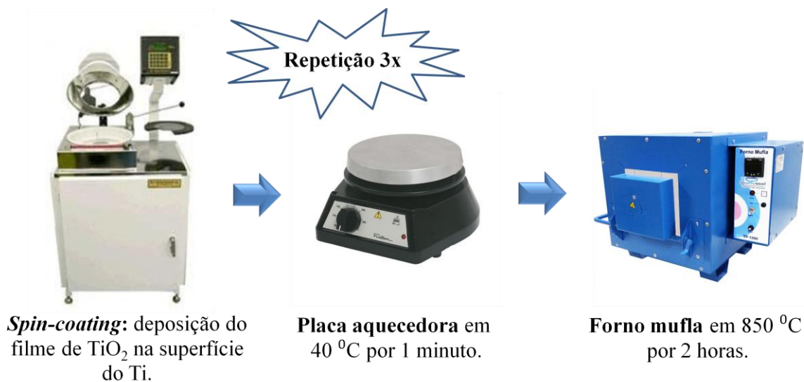
Figura 9. Processo de deposição do filme de TiO 2 nas superfícies. Fonte: produzido pelo autor.
