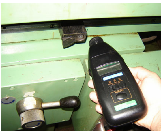
Figura 26 – Tacômetro utilizado na medição da velocidade tangencial da mesa retificadora
