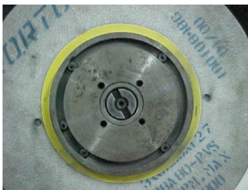
Figura 24 – Massas de metal utilizadas para o balanceamento do rebolo
