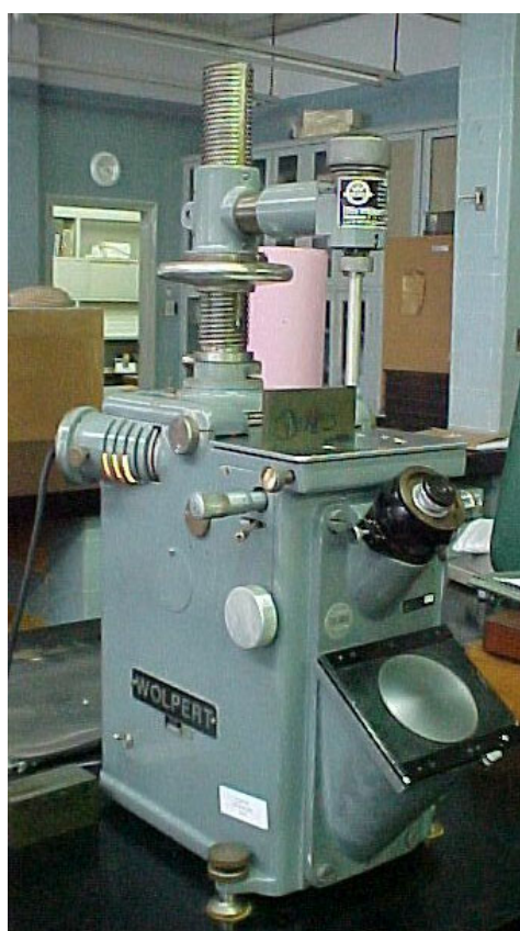
Figura 33 – Equipamento de medição de microdureza
