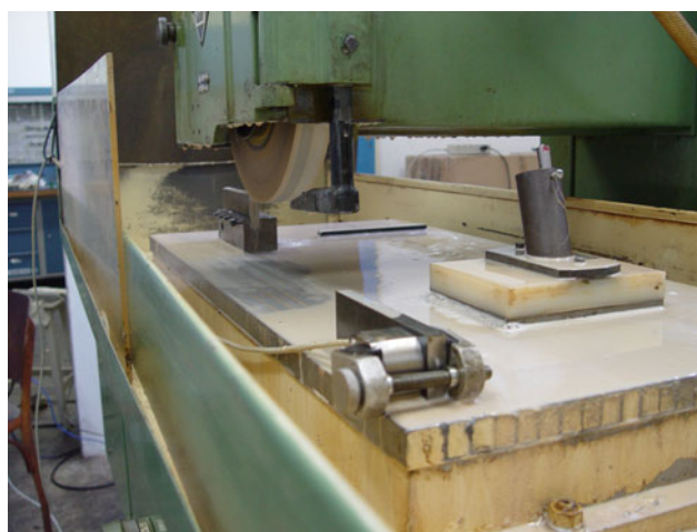
Figura 38 – Processo de usinagem utilizado no banco de ensaios
