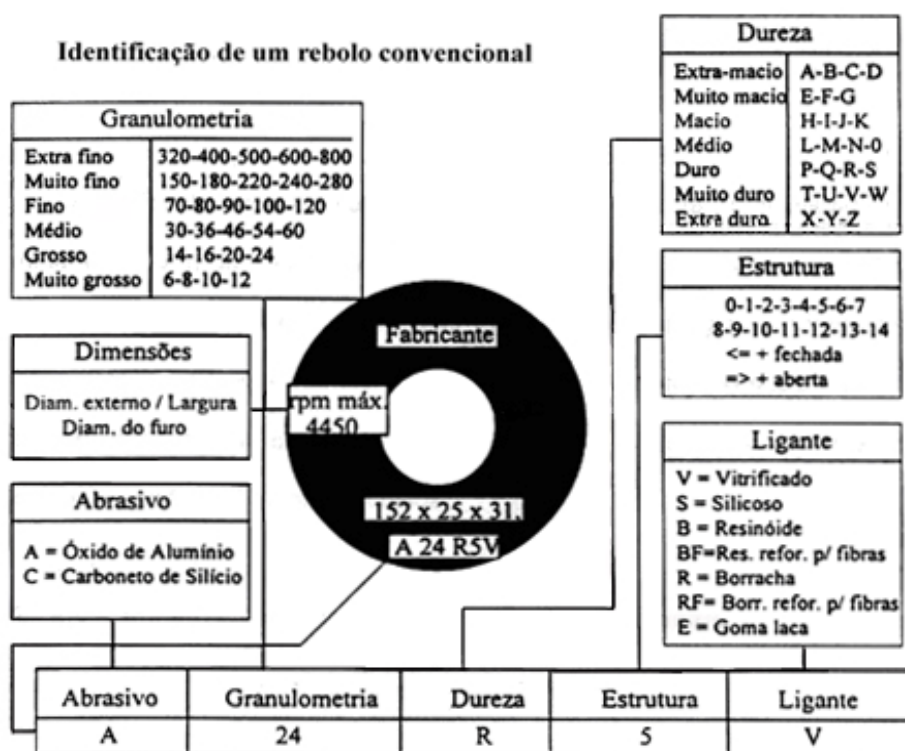
Figura 8 – Especificação de rebolos com abrasivos convencionais (Stemmer, 1992)
