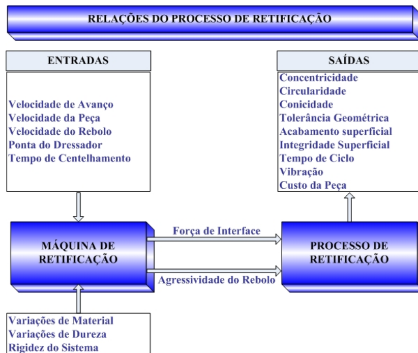
Figura 3 – Variáveis de entrada e saída para máquinas e processos de retificação (Adaptado de King & Hahn, 1986).
