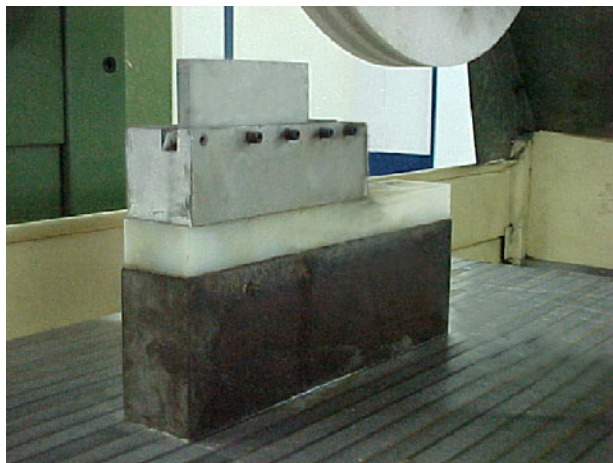
Figura 25 - Fixação e alinhamento do corpo de prova na máquina retificadora
