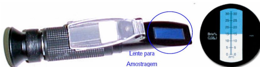
Figura 22 – Refratômetro utilizado na medição da concentração do fluido de corte
