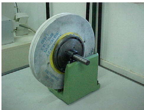
Figura 23 – Suporte utilizado no balanceamento do rebolo
