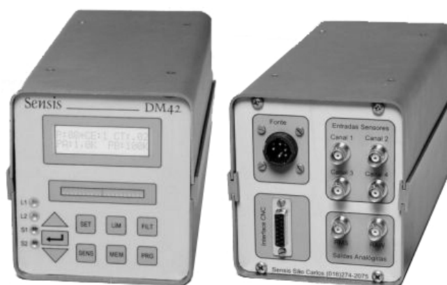
Figura 29 – Sistema de monitoração de EA do fabricante Sensis
