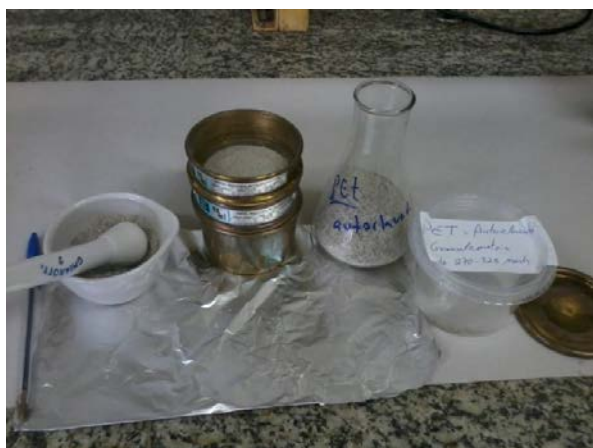
Figura 42 – Trituração do adsorvente PET.
