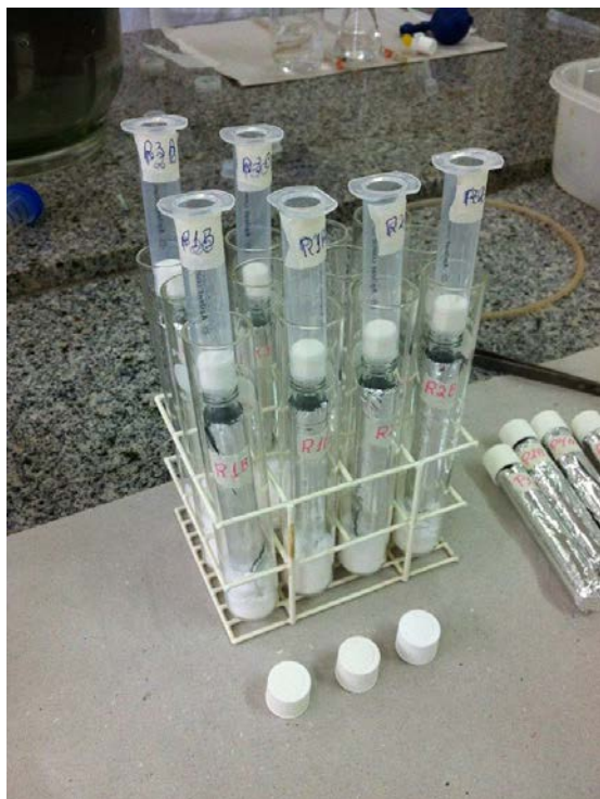
Figura 27 – Eluição do eluato dos cartuchos c-18.
