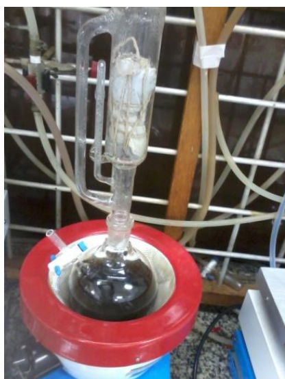
Figura 40 – Lavagem da TPMAN em Soxhlet.
