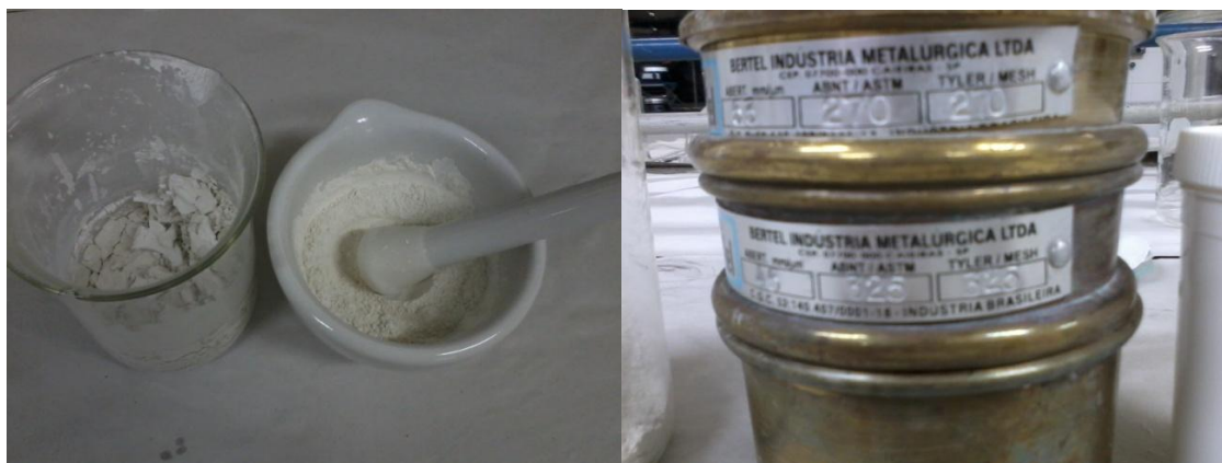
Figura 38 – Trituração e peneiração da Mo-DDP.
