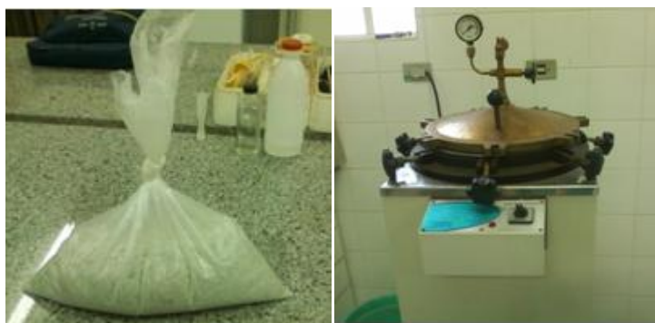
Figura 41 – Ativação do PET em autoclave.
