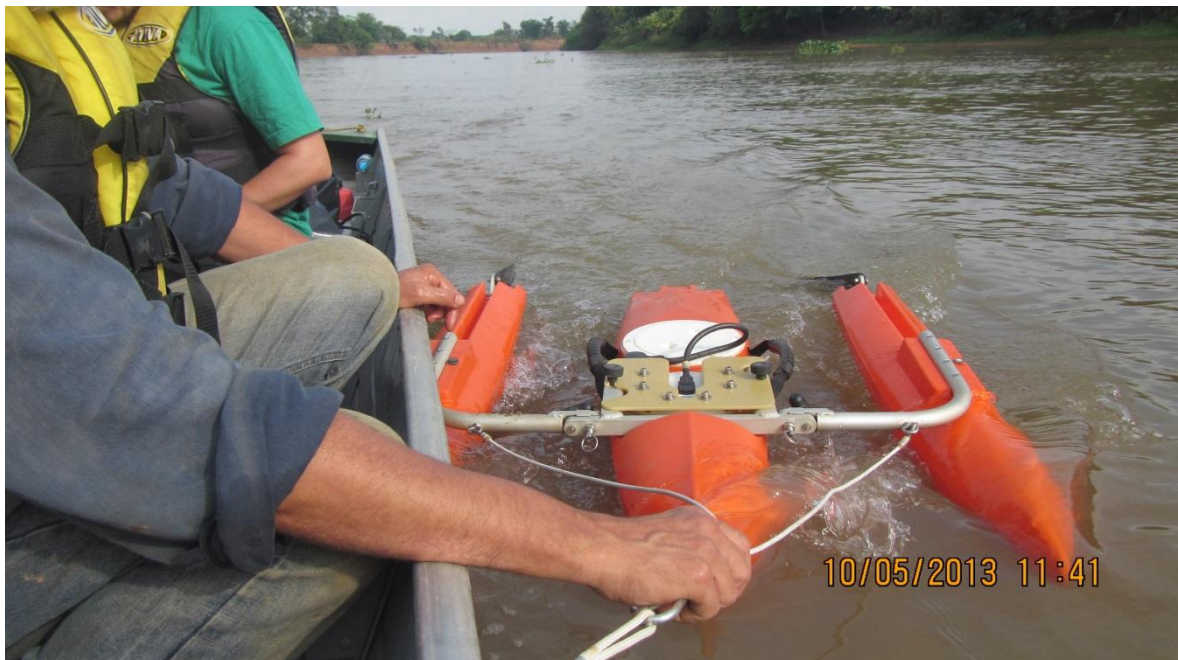
Figura 8: ADCP fixado em um flutuador preso a um barco.
