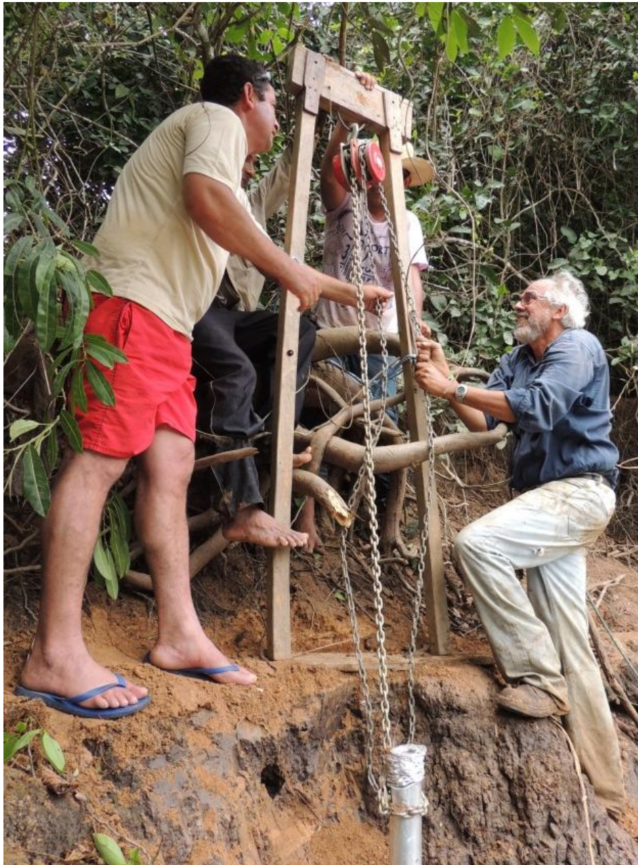
Figura 6: Perfuração do terreno utilizando a técnica de vibro-testemunhador; Retirada do testemunho do terreno utilizando talha manual
