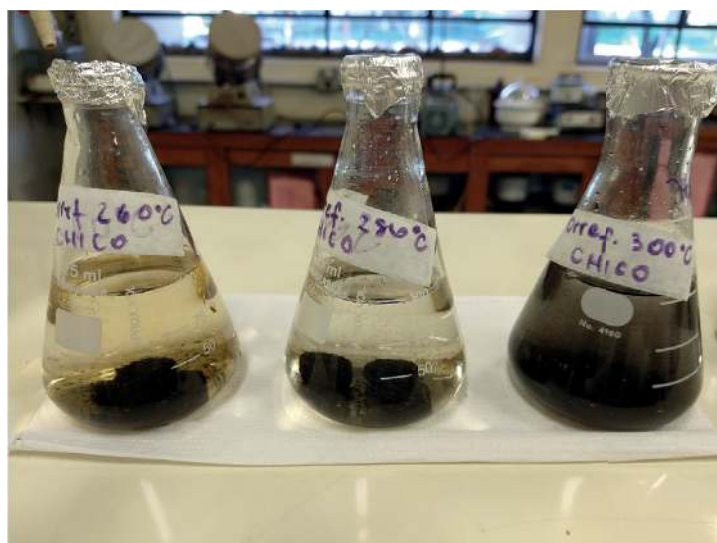
Fig. 5. Estabilidade em meio aquoso dos péletes de torrefação a 260°C, 280°C e 300°C.
