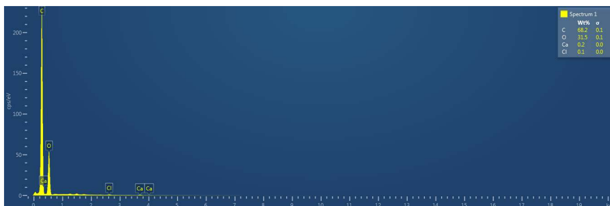
Figura 26 – EDS do biocarvão CA2MM
