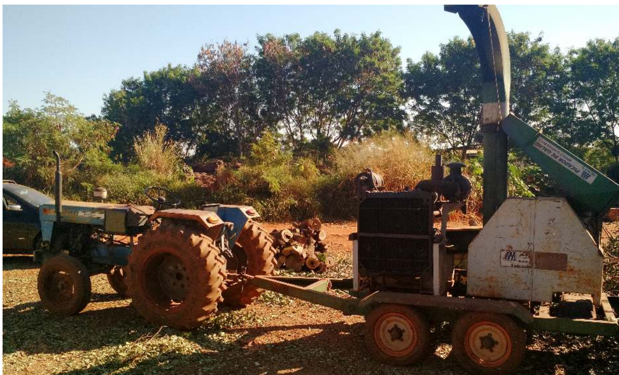
Figura 3 – Sistema de beneficiamento de poda urbana do município de Araraquara
