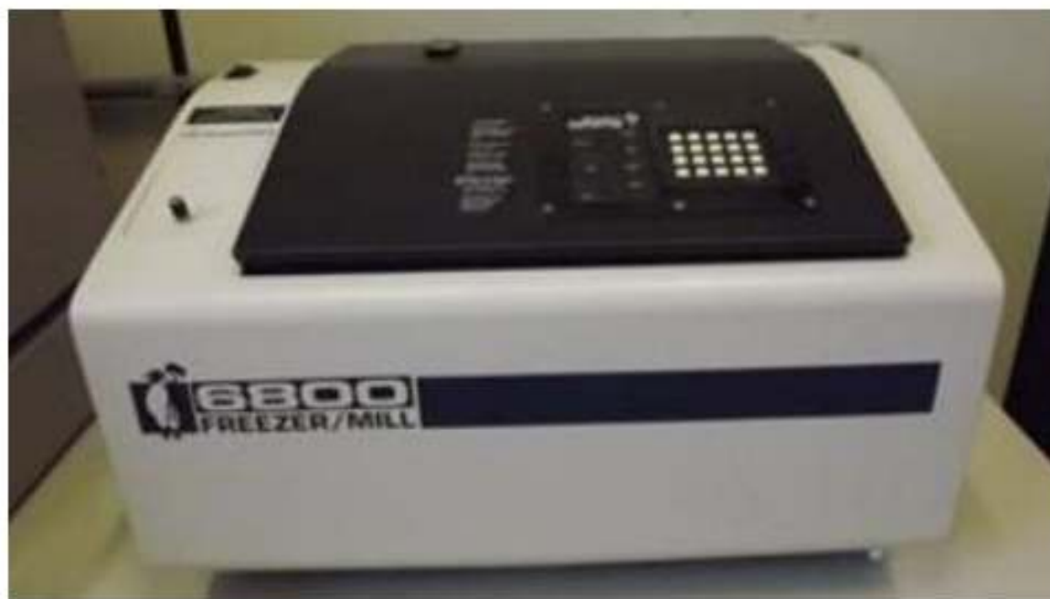
Figura 5 – Moedor criogênico Spex Certiprep 6800 Freezer/Mill
