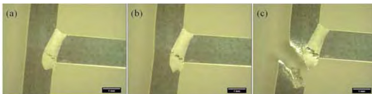
Figura 67 - Imagens do monitoramento do ensaio de tração Hoop do cdp tratado a 190 °C por quatro horas, (a) nucleação da trinca, (b) propagação da trinca e (c) ruptura do cdp.
