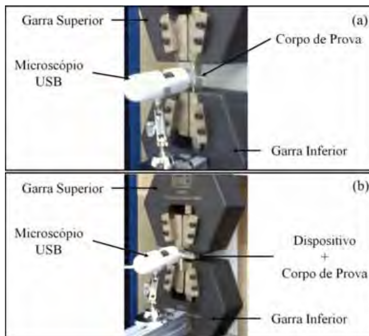
Figura 35 - Monitoramento do Ensaio de Tração, (a) Hoop e (b) T-Pull .
