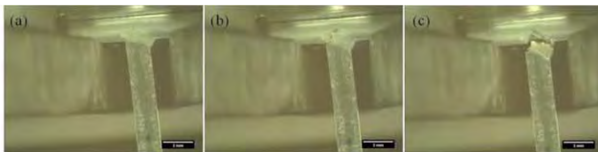
Figura 70 - Imagens do monitoramento do ensaio de tração T-Pull do cdp tratado a 190 °C por quatro horas, (a) nucleação da trinca, (b) propagação da trinca e (c) ruptura do cdp.
