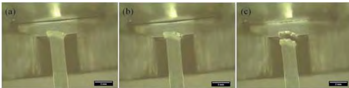
Figura 71 - Imagens do monitoramento do ensaio de tração T-Pull do cdp tratado a 205 °C por duas horas, (a) nucleação da trinca, (b) propagação da trinca e (c) ruptura do cdp.
