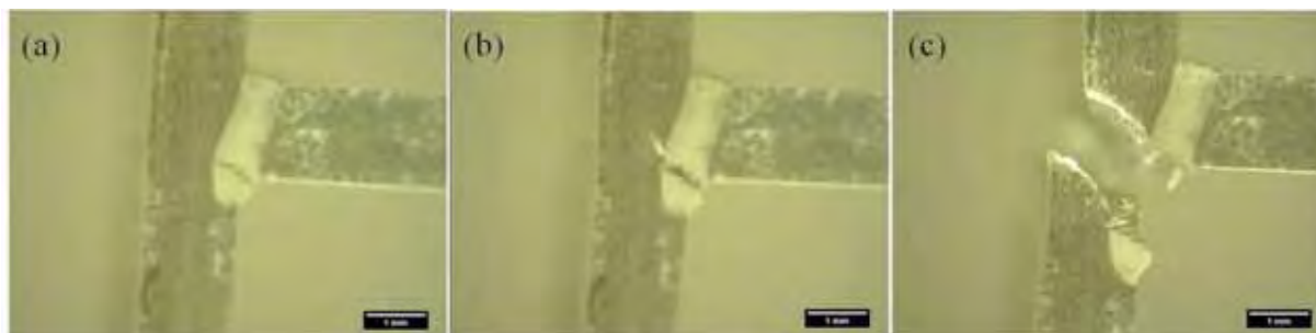
Figura 68 - Imagens do monitoramento do ensaio de tração Hoop do cdp tratado a 205 °C por duas horas, (a) nucleação da trinca, (b) propagação da trinca e (c) ruptura do cdp.
