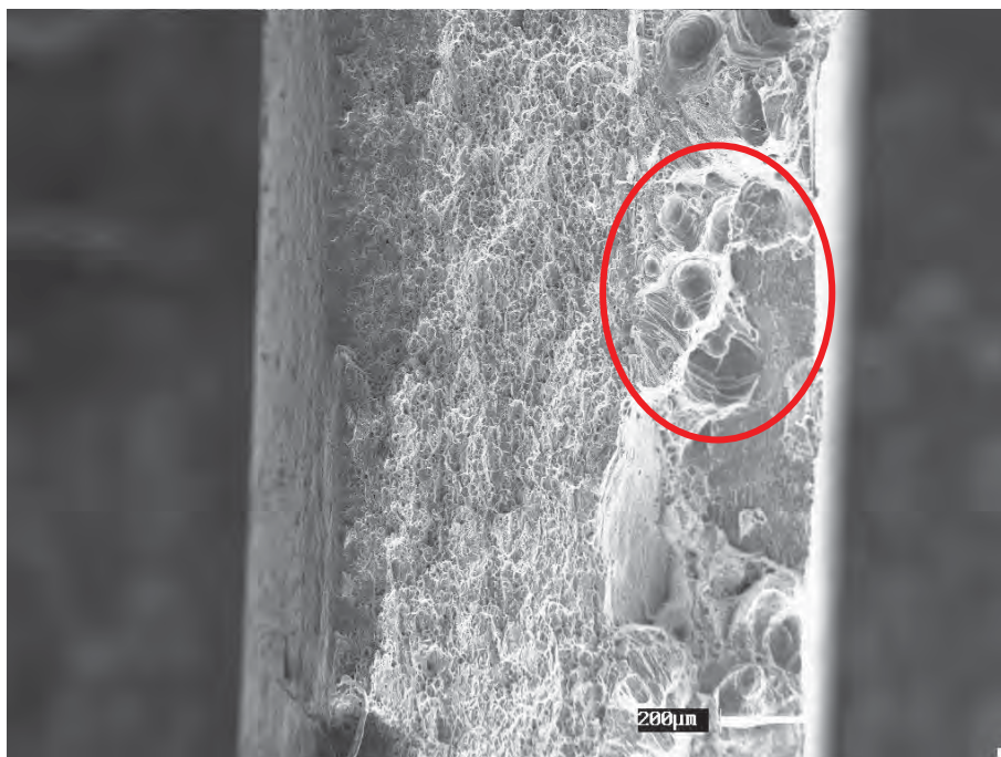
Figura 75 – MEV: Macrografia de um segundo corpo de prova submetido a ensaio de fadiga nas mesmas condições do primeiro cdp.
