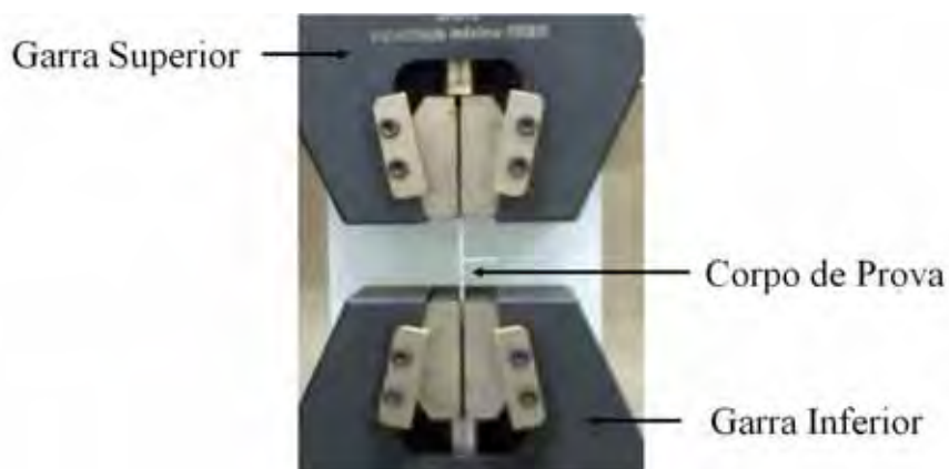
Figura 30 - Esquema do corpo de prova de ensaio de tração Hoop .
