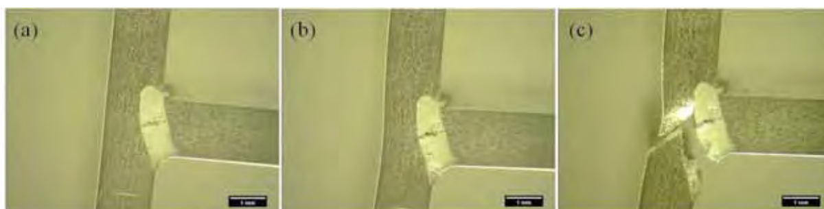
Figura 66 - Imagens do monitoramento do ensaio de tração Hoop do cdp sem tratamento térmico, (a) nucleação da trinca, (b) propagação da trinca e (c) ruptura do cdp.
