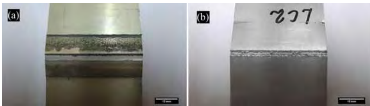
Figura 82 - Macrografias da superfície de fratura dos cdp's: FSW (a) e LBW (b).
