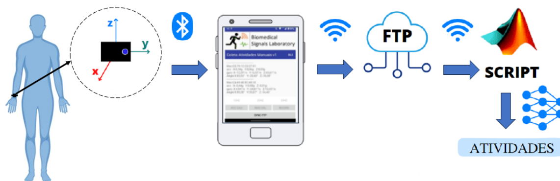
Figura 3 – Sistema de medição utilizado no estudo, mostrando a integração do sensor inercial, a transmissão de dados via FTP e o processamento dos dados no MATLAB®.
