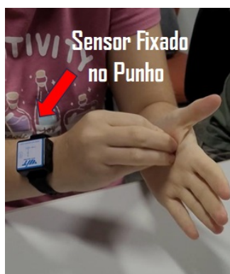
Figura 4 – Posição de fixação do sensor inercial no punho direito dos participantes durante a execução dos movimentos de higienização das mãos.
