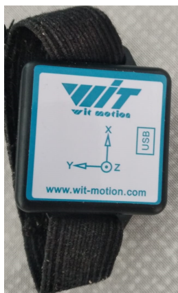
Figura 1 – Sensor inercial WitMotion WT901BLECL utilizado para registrar os movimentos durante as coletas de dados.
