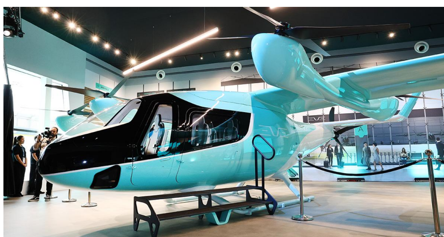
Figura 14 – Aplicação de sistemas propulsivos em tandem no protótipo da EVE Air Mobility.
