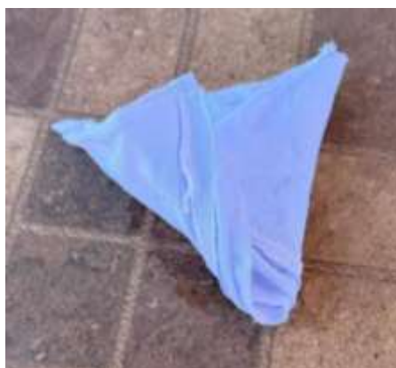
Figura 10 – Amostra de adesivo envolvida em tecido de algodão
