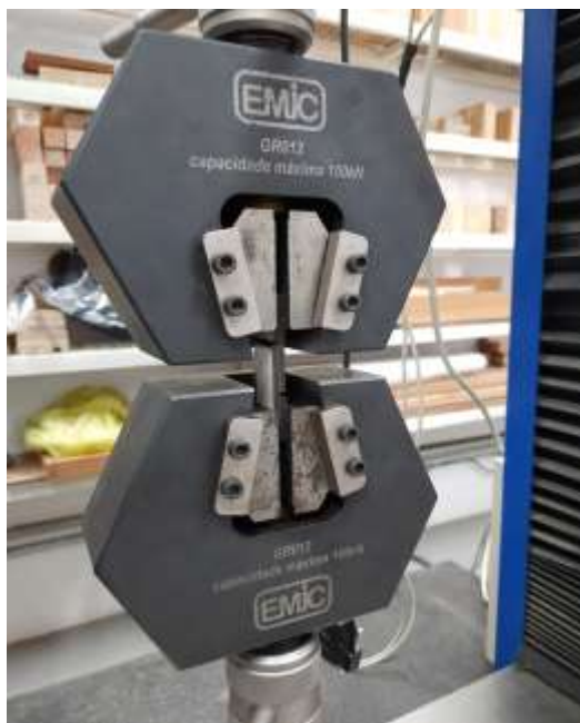
Figura 9 – Corpo de prova fixado para teste de cisalhamento
