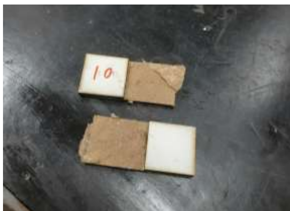
Figura 14 – Corpo de prova após o teste de resistência ao cisalhamento
