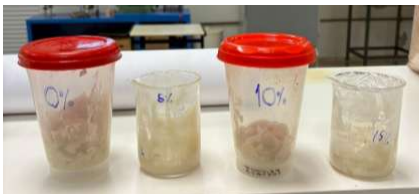
Figura 13 – Adesivo de amido com 0%, 5%, 10% e 15% de fibras de algodão
