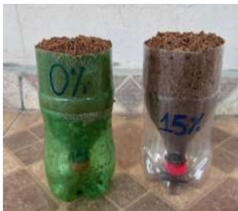
Figura 11 – Amostras soterradas em garrafa PET
