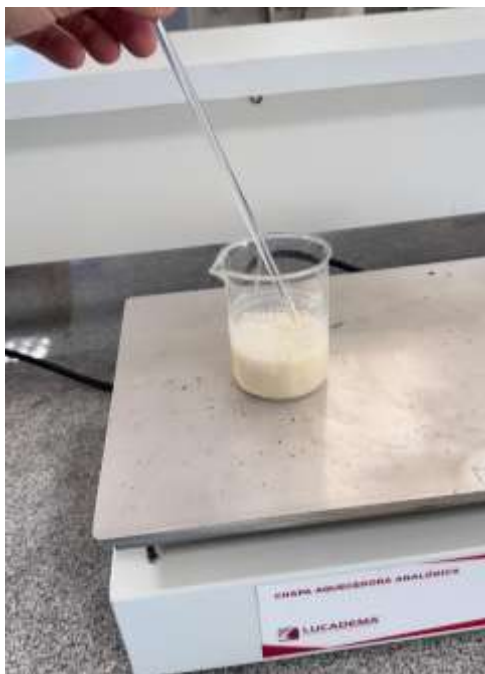
Figura 6 – Suspensão de amido de trigo e água preparada na chapa aquecedora
