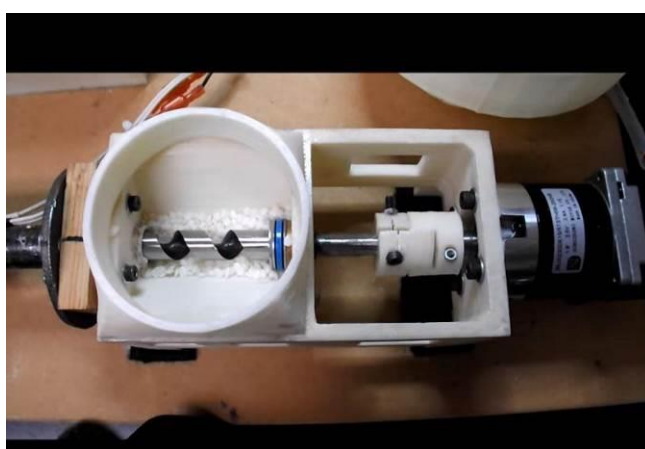
Figura 14 - Sistema de adição de particulado, quinta versão da máquina de Lyman
