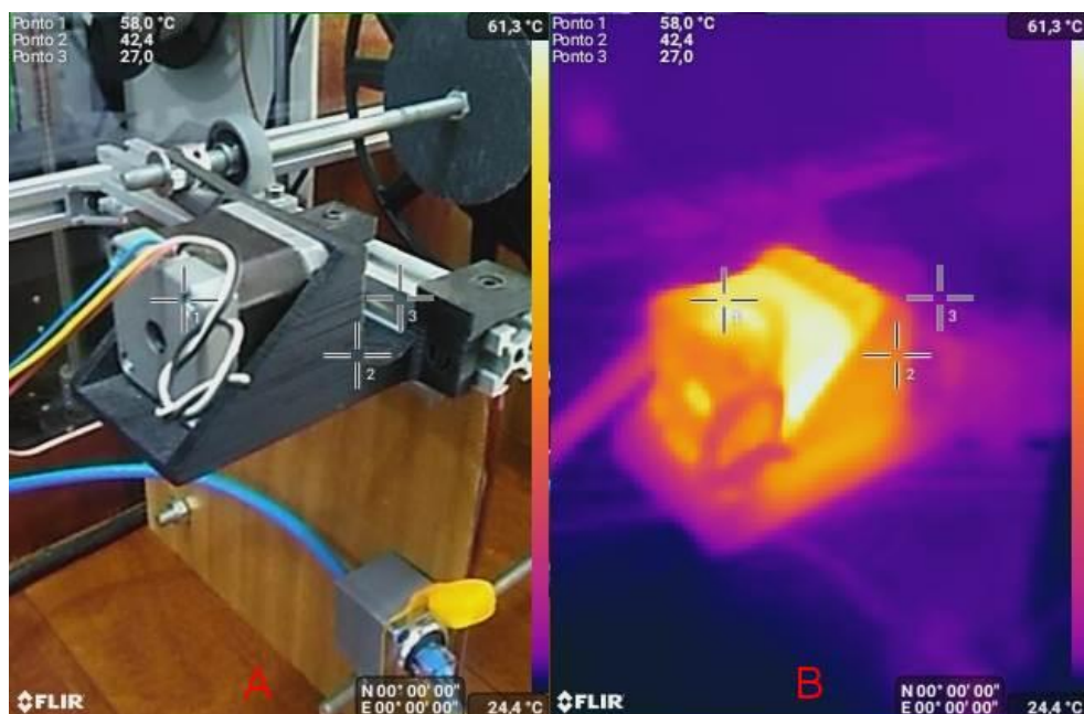
Figura 41 - Análise térmica do sistema bobinador, no qual (A) foto com análise térmica em três pontos e (B) análise térmica geral
