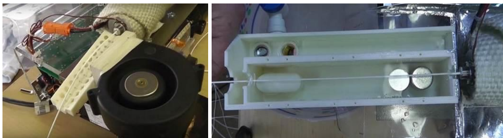
Figura 17 - Sistemas de resfriamento de polímeros extrudados. Em (a) resfriamento a ar e (b) resfriamento a água
