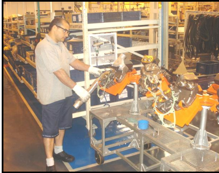
Figura 7: Montador manuseando a peça no novo carrinho Fonte: Material elaborado pelos colaboradores participantes do Kaizen (2011)
