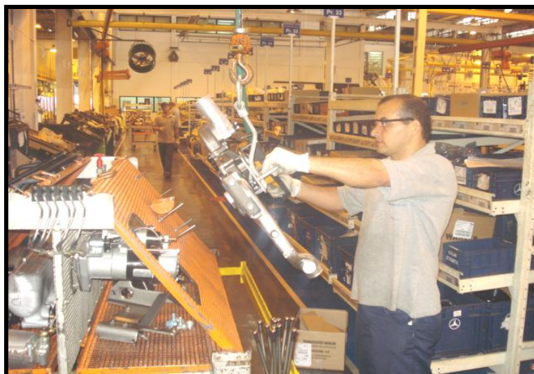
Figura 10: Montador transporta a peça montada para o carrinho kit com talha e gancho adequado Fonte: Material elaborado pelos colaboradores participantes do Kaizen (2011)
