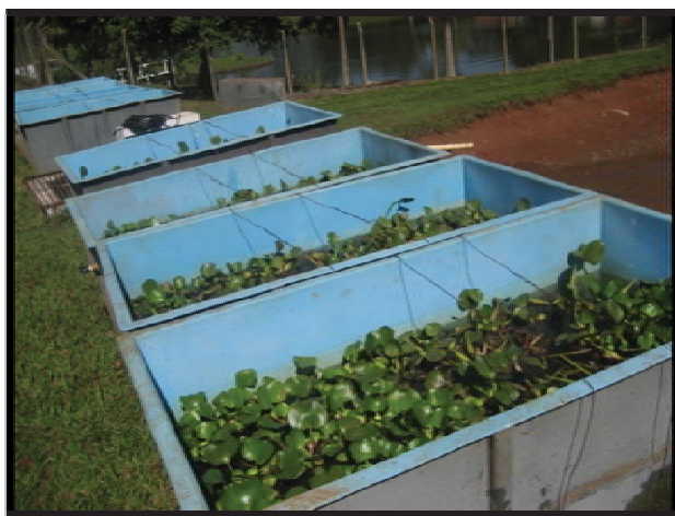
Figura 2. Sistemas de tratamento de efluentes utilizados nos experimentos do Capítulo 4. Wetlands construídas para o tratamento de efluentes de despesca de viveiros de camarão-da-amazônia.
