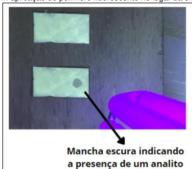
Figura 23 - Imagem explicativa tirada durante os experimentos de uma placa de alumínio com aplicação de polímero fluorescente no lugar da sílica.
