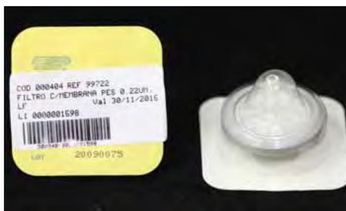
**FIGURA 3** - Filtro com membrana esterilizadora.
