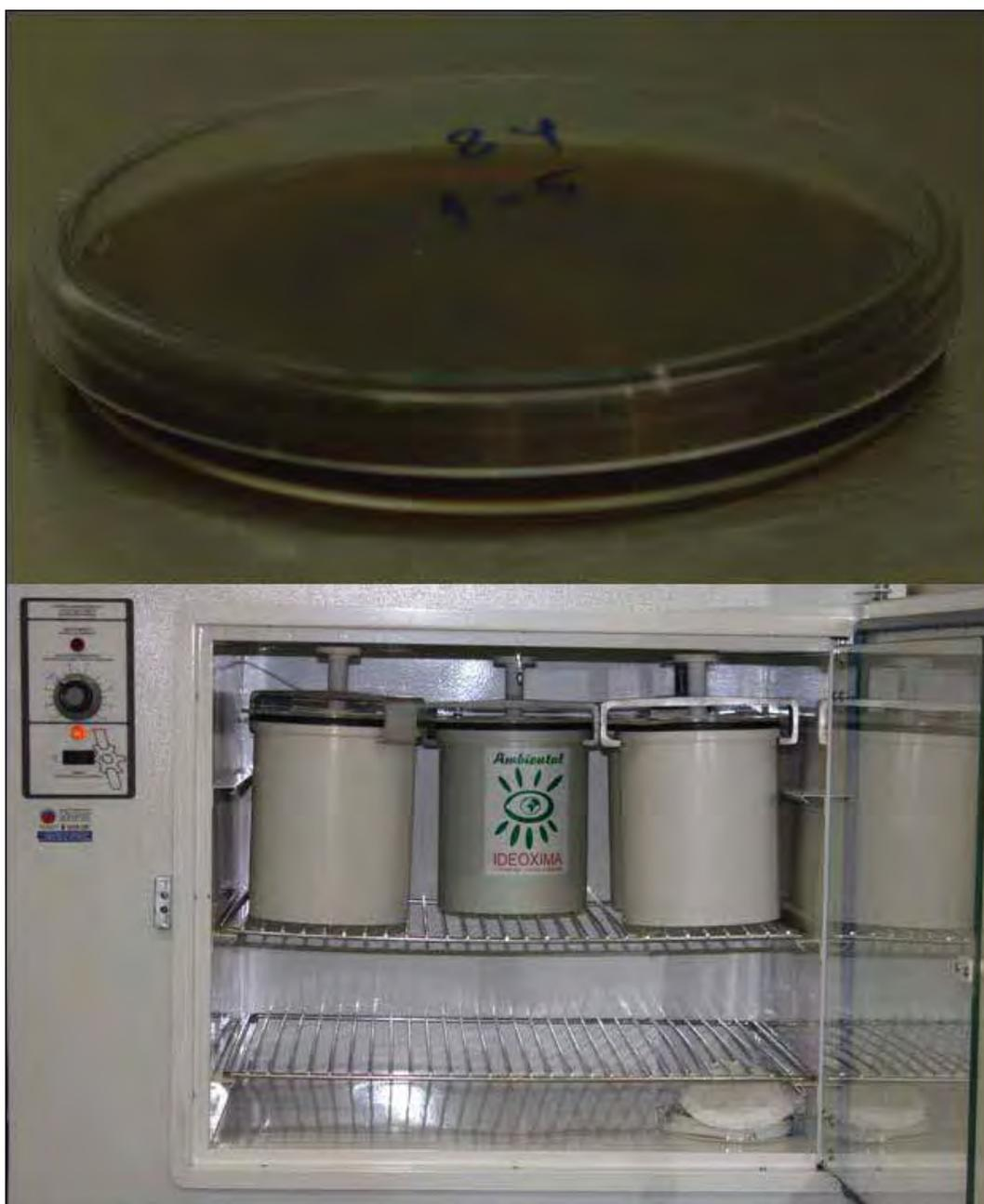
**FIGURA 10** - Identificação das placas e colocação das mesmas em estufa em condições de microaerofilia à  $37^{\circ}\text{C}\pm 1$ .
