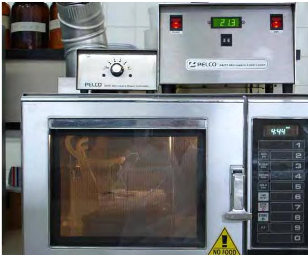
Figura 4.5 – Microondas utilizado para descalcificação das peças.
