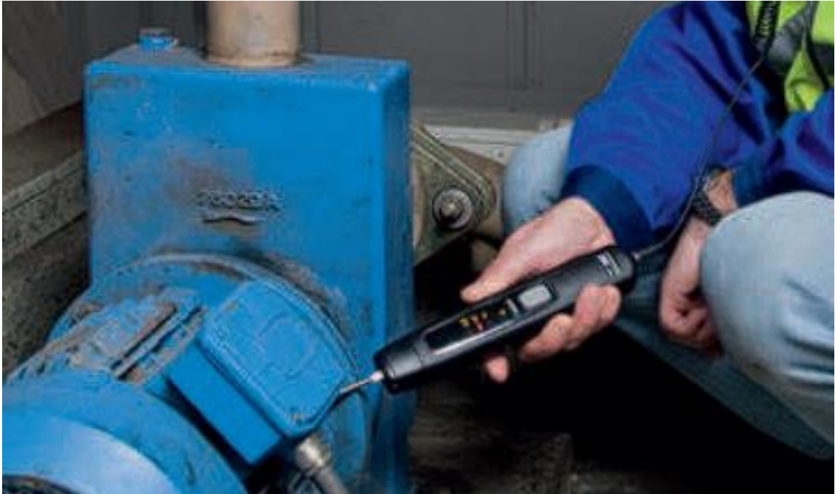
Figura 26 – Exemplo de aplicação de um estetoscópio eletrônico na detecção de defeitos
