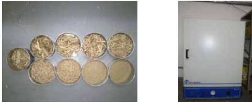
Figura 20 - Amostras e forno utilizados no processo de teor de umidade.
