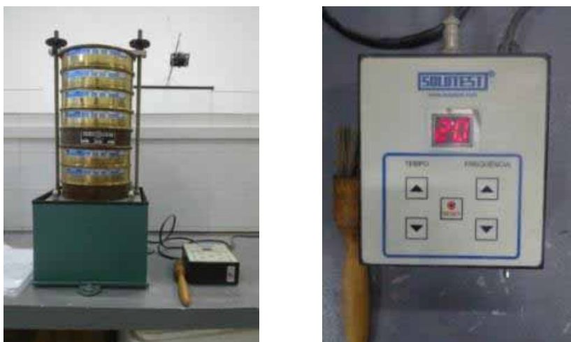
Figura 19 - Agitador de peneiras eletromagnético programado para 20 minutos.
