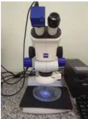
Figura 25 - Microscópio marca ZEISS modelo Stemi 2000 utilizado para medição de partículas menores.
