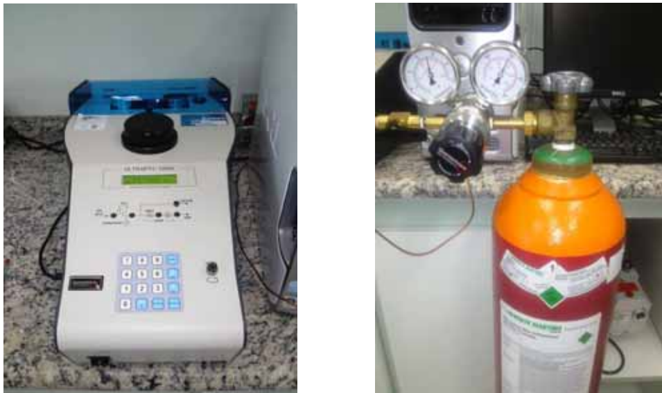
Figura 28 - Picnômetro a gás hélio.
