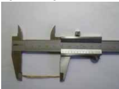
Figura 26- Paquímetro utilizado para medir partículas maiores.
