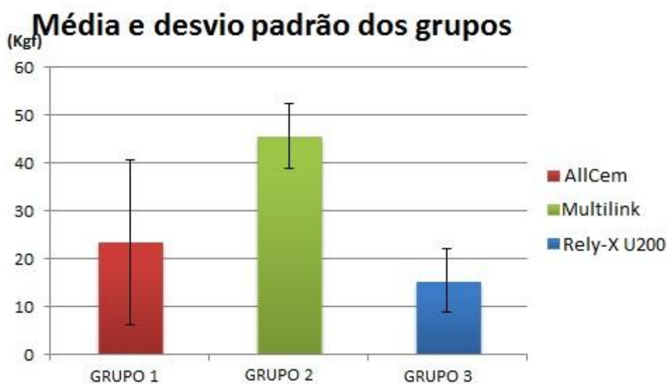
Figura 10 - Ilustração gráfica dos valores médios de resistência de união à tração (kgf) e desvio padrão para os agentes cimentantes.
