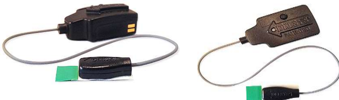
Fig. 1 - Eletrodo não invasivo de EMGs da Delsys, composto por um sensor denominado eletrodo de registro e um eletrodo de referência.
