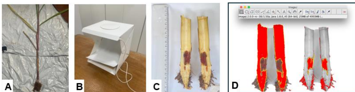
Figura 11 - Avaliação do dano utilizando programa ImageJ ®. A - Preparo da planta para fotografia; B - Cabine para captura das imagens; C - Imagem do colmo obtida para análise; D - Processamento da imagem.
