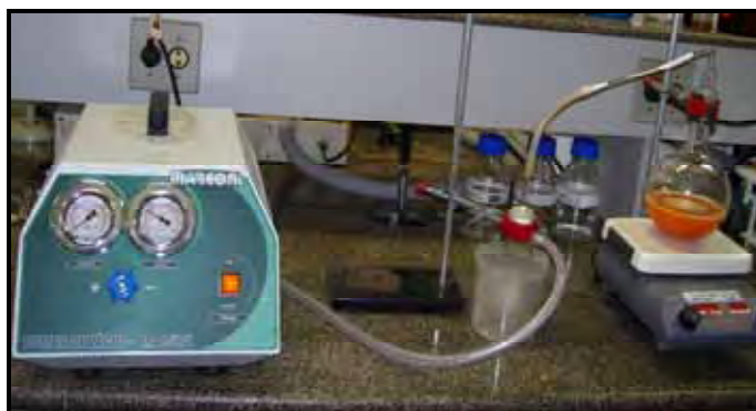
Figura 1. Sistema de captura dos compostos voláteis da polpa de uvaia por sucção a vácuo.
