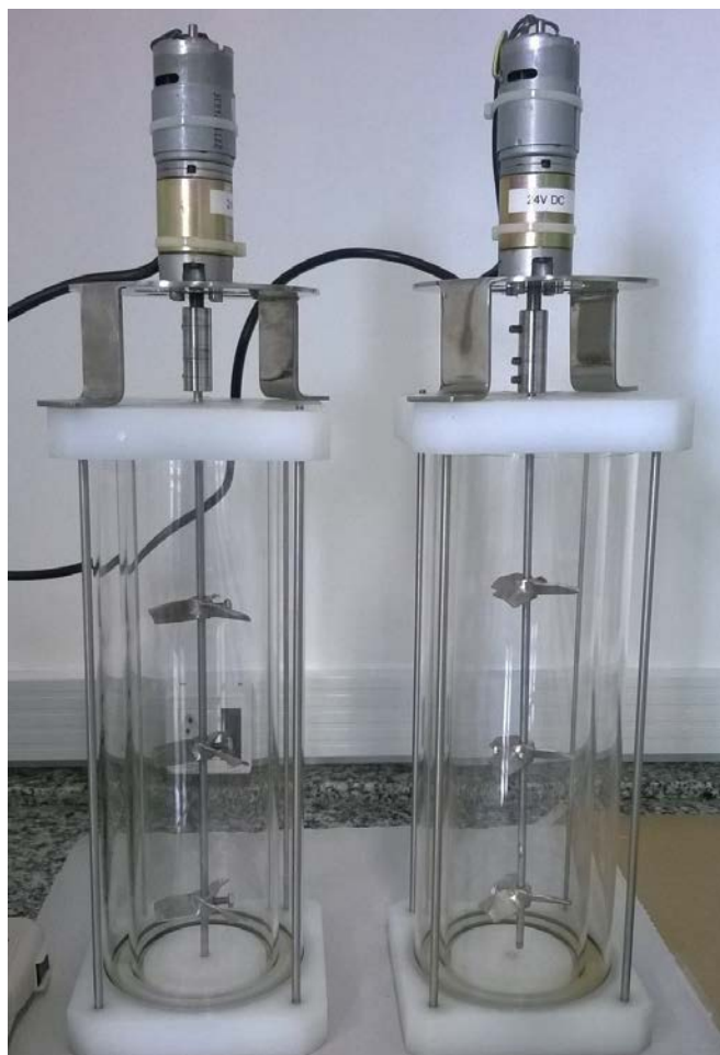
Figura 18 - Célula analítica desenvolvida para medidas com ISE em meio aquoso
