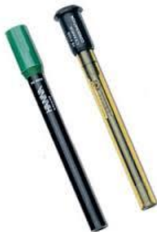
Figura 13 - Imagem de um eletrodo seletivo (esquerda) com um eletrodo de referência (direita)
