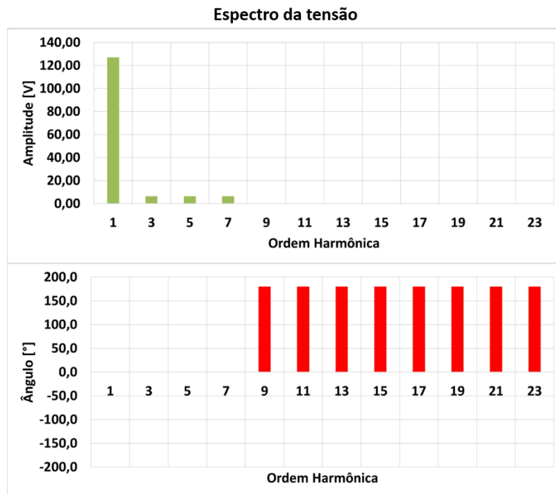
Figura 29 - Espectro Harmônico da Tensão para carga FTH (Condição 1).
