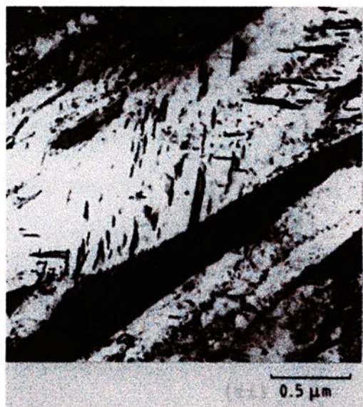
FIGURA 2.8. Microestrutura da bainita inferior mostrando partículas de carboneto no interior da ferrita bainítica. (Honeycombe e Bhadeshia, 1995).
