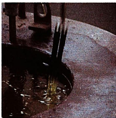
FIGURA 3.3 – Forno de banho de sal do LTT – IAE/AMR/CTA.
