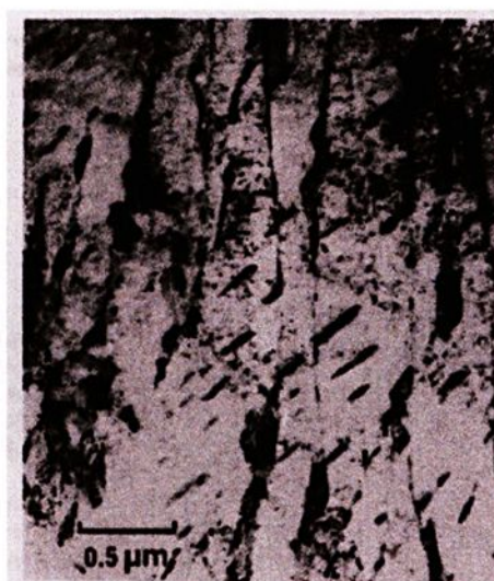
FIGURA 2.10. Micrografia da bainita inferior realizada através de microscopia eletrônica de transmissão (Honeycombe e Bhadeshia, 1995)
