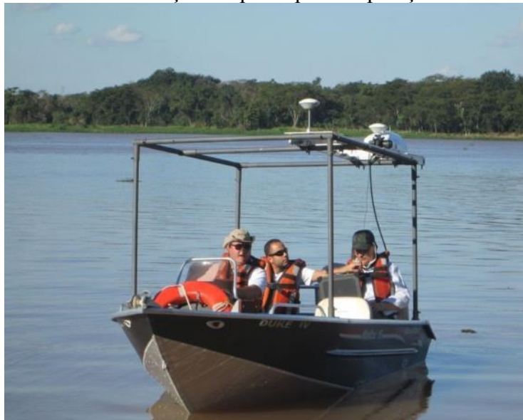
Figura 10: Primeira embarcação adaptada para a operação do escâner LASER.
