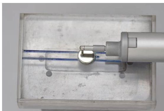
Figura 10- Posicionamento da ponta do rugosímetro paralela à marcação em forma de linha superior.
