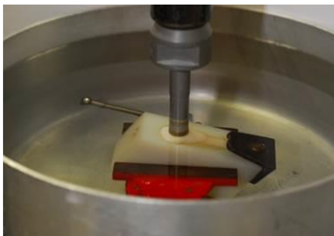
3b- Dispositivo fixado no suporte do aparelho para que pudesse ficar estável durante o corte.
