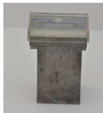
Figura 7- Dispositivo sobre o suporte para leitura da rugosidade superficial.
