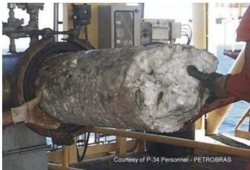
Figura 2.12 - Hidrato em um poço da plataforma P-34 da Petrobras (banco de imagem da Petrobras
