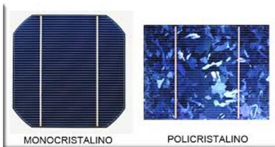
Figura 4: Célula de silício monocristalino e de silício policristalino.
