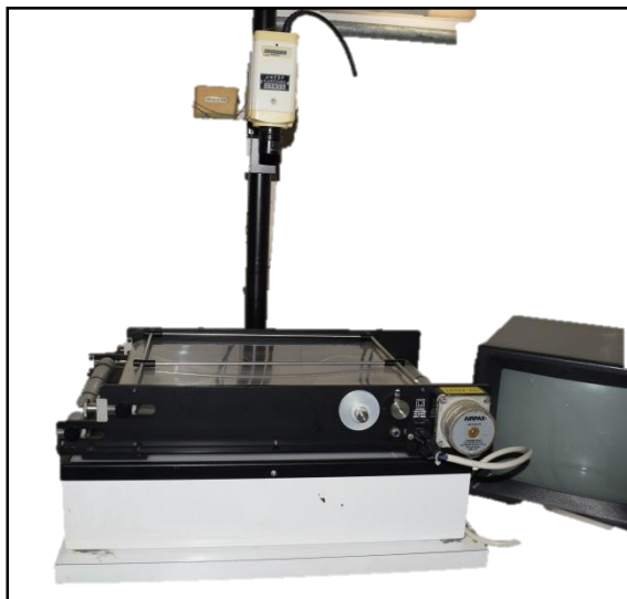
Figura 14. Sistema Digital de Análise de Imagem-Delta T Devices usado para quantificação da área a partir do desenho da lesão no caule causada por Phytophthora cinnamomi em mudas de abacateiro.
