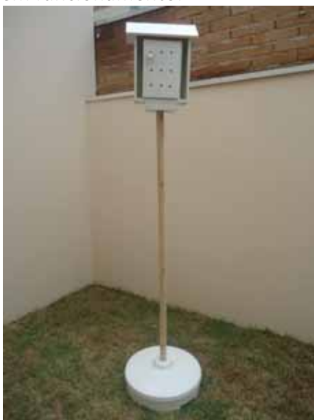
Figura 43. Estrutura completa e vista interna do mini abrigo com o aparelho DATA LOGGER em funcionamento.
