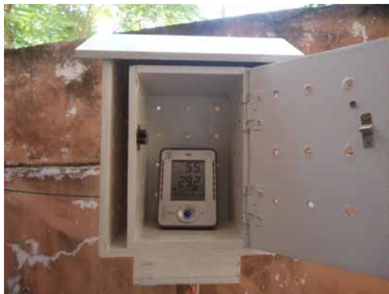
Figura 43. Estrutura completa e vista interna do mini abrigo com o aparelho DATA LOGGER em funcionamento.
