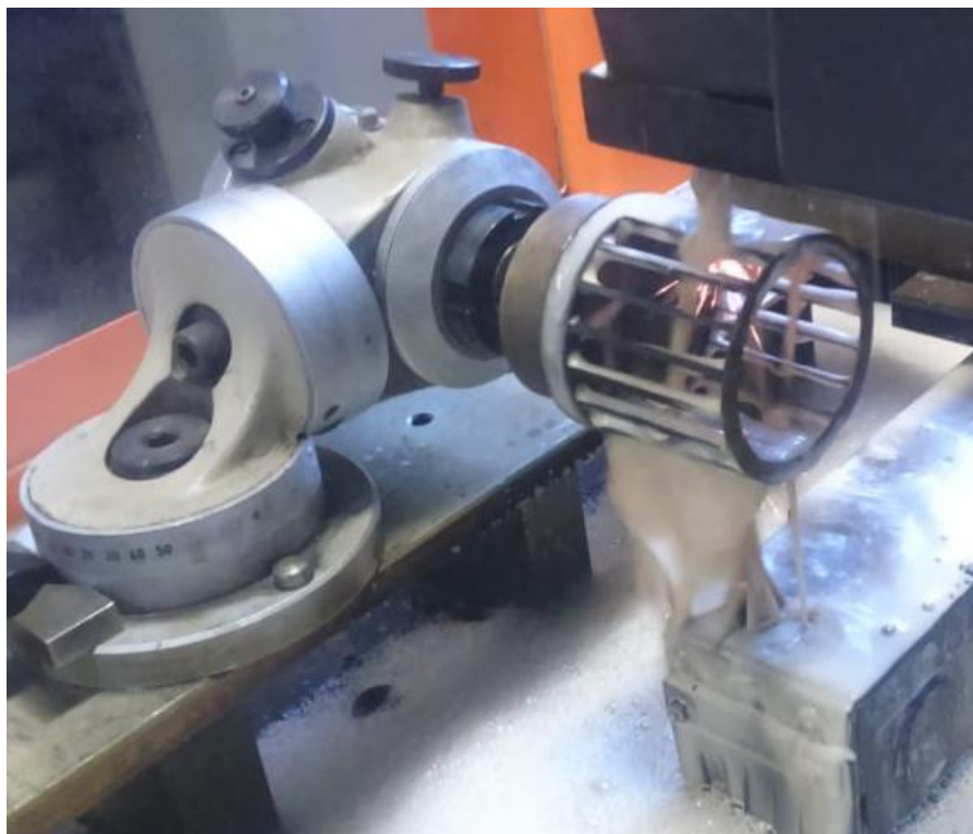
Figura 15. Corte dos cdps em eletroerosão a fio.
