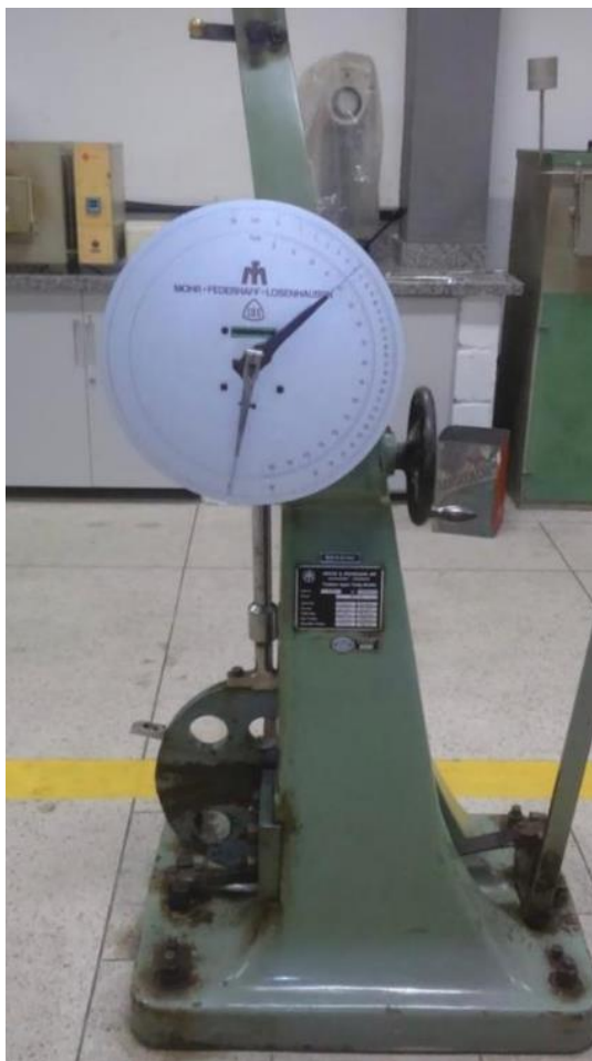
Figura 23. Equipamento de ensaio de impacto Charpy.
