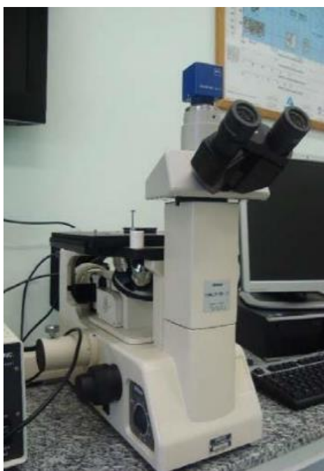
Figura 25. Microscópio EPIHOT 200 e câmera AxioCam ERc 5s.
