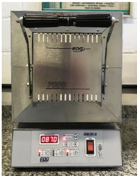
Figura 20. Austenitização dos corpos de prova.
