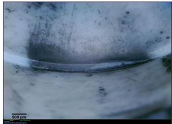
Figura 35 (b) - V_c = 500\text{m/min} , f = 0,5\text{mm/rot} , a_p = 0,25\text{mm} , VB_{\text{máx}} = 0,149\text{mm}
