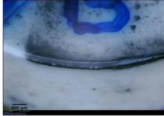
Figura 38 (a) - V_c=700\text{m/min} , f=0,3\text{mm/rot} , Figura 38 (b) - V_c=700\text{m/min} , f=0,3\text{mm/rot} , a_p=0,25\text{mm} , VB_{\text{máx}}=0,222\text{mm} a_p=0,25\text{mm} , VB_{\text{máx}}=0,222\text{mm}
