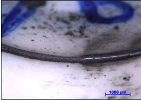
Figura 38 (a) - V_c=700\text{m/min} , f=0,3\text{mm/rot} , Figura 38 (b) - V_c=700\text{m/min} , f=0,3\text{mm/rot} , a_p=0,25\text{mm} , VB_{\text{máx}}=0,222\text{mm} a_p=0,25\text{mm} , VB_{\text{máx}}=0,222\text{mm}
