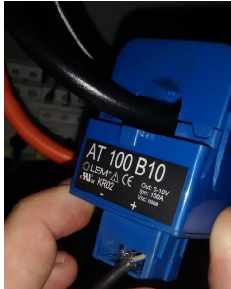
Figura 25 - Sensor de transdução de corrente da marca LEM, modelo AT 100 B10
