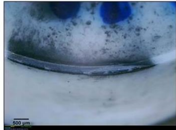
Figura 37 (b) - V_c = 600\text{m/min} , f = 0,5\text{mm/rot} , a_p = 0,25\text{mm} , VB_{\text{máx}} = 0,170\text{mm}
