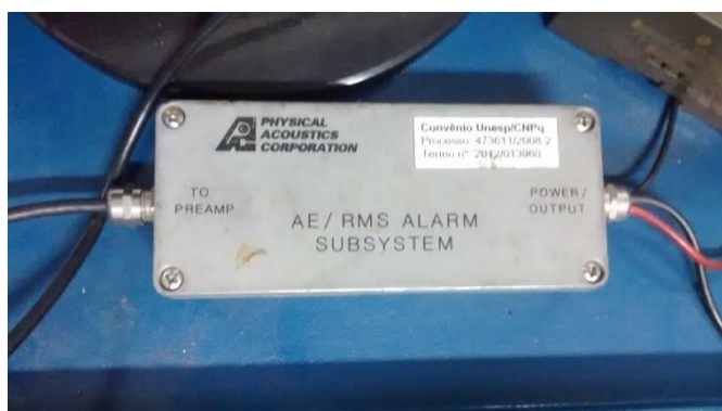
Figura 26 - Sistema de captação da emissão acústica da marca Physical Acoustics Corporation
