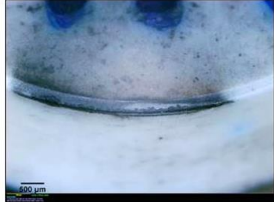
Figura 36 (b) - V_c = 600\text{m/min} , f = 0,3\text{mm/rot} , a_p = 0,25\text{mm} , VB_{\text{máx}} = 0,181\text{mm}
