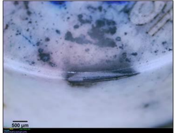
Figura 32 (b) - V_c = 400\text{m/min} , f = 0,5\text{mm/rot} , a_p = 0,25\text{mm} , VB_{m\acute{a}x} = 0,184\text{mm}
