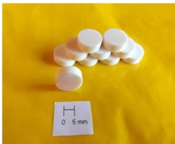
Figura 23 - Ferramentas de corte redondas de geometria RNGN120400-T0220 de acordo com a norma ISO1832.
