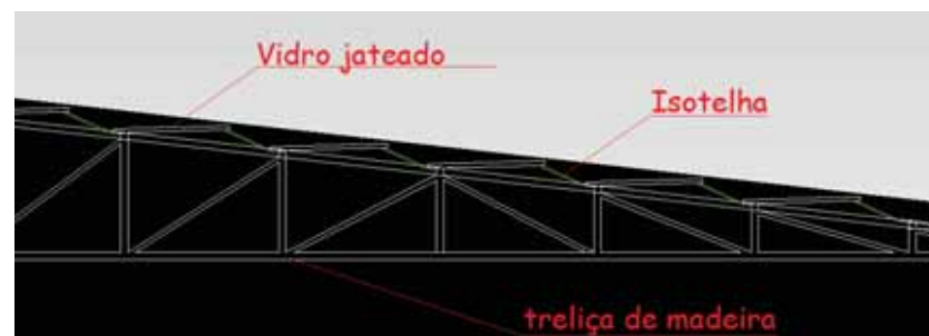
Figura 69 –Esquema do Shed inclinado (Fonte: http://www.isoeste.com.br )
