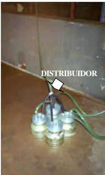
Figura 2 – Distribuidor de vácuo aos latões (Seta)
