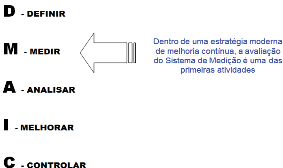
Figura 24 – Passos para a melhoria do sistema de medição (HARRY, 2000).
