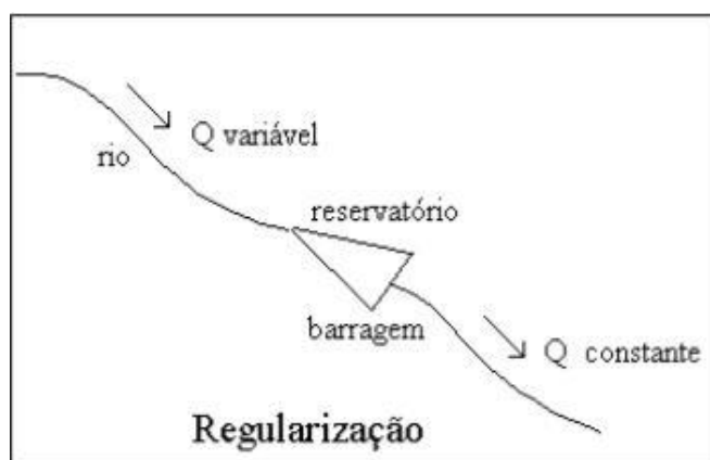
Figura 4.1.1: Esquema de regularização de vazão em um curso d'água natural.
