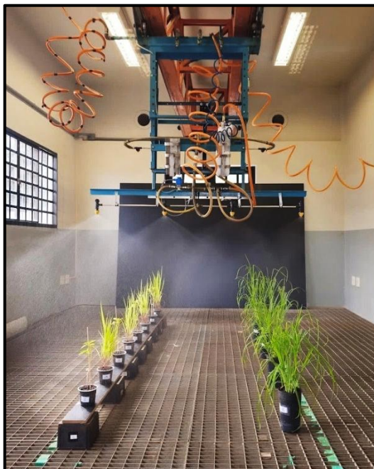
Figura 1 - Aplicação dos tratamentos utilizando pulverizador estacionário instalado em ambiente fechado no laboratório do NUPAM (Botucatu, SP)
