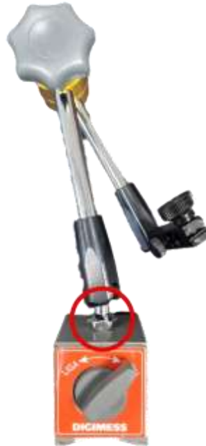
Figura 43 – Local de folga na fixação entre o braço hidráulico e a base magnética
