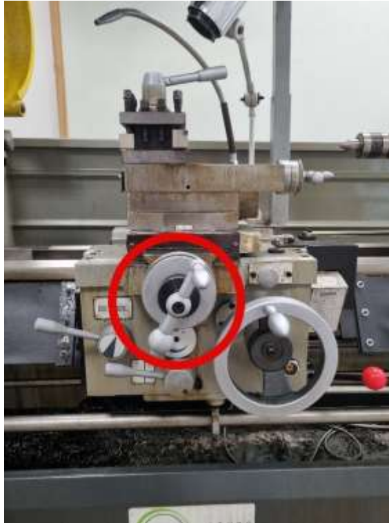
Figura 44 – Manivela de regulagem transversal do torno mecânico horizontal
