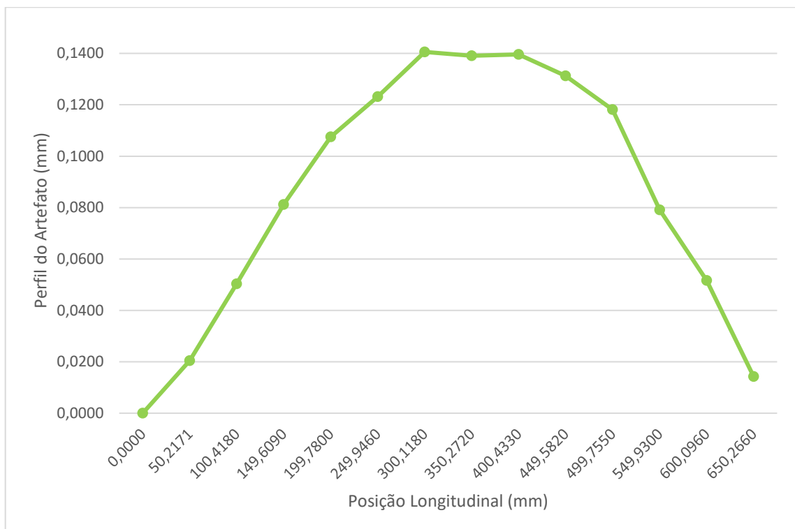
Figura 23 – Perfil do artefato de aço 1045 com oxidação negra e faces de medição retificadas
