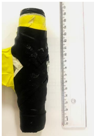
Figura 3.1 – Imagem do sensor BAC real utilizados nesse trabalho, sensor B1C composto por 1 par de bobinas de excitação e 1 par de bobinas detecção.
