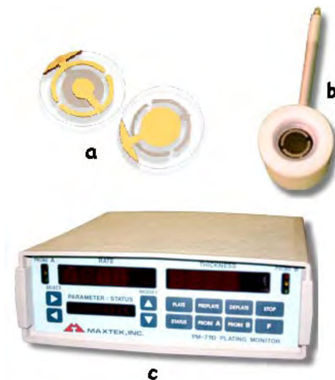
Figura I.18: Microbalança de Cristal de Quartzo e seus acessórios: a) cristal de quartzo, nestecaso com superfície de ouro; b) probe modelo TPS-550; c) microbalança de cristal de quartzo PM-700 Series Plating Monitors.
