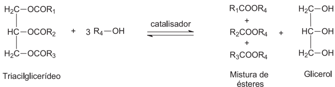
Figura 1: Reação de transesterificação para produção de biodiesel
